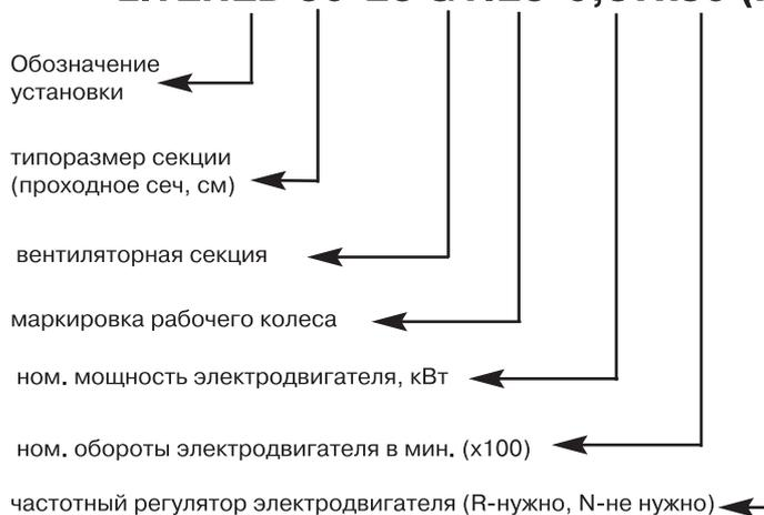
В каждом типоразмере существует несколько вариантов вентиляционных агрегатов, чем обеспечивается легкий подбор под необходимые проектные требования.
