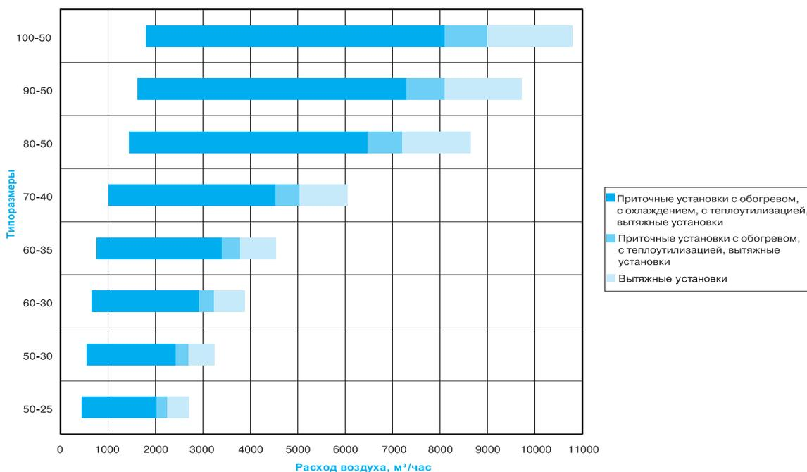
Типоразмерный ряд обозначается по внутреннему условному проходному сечению установок. Ниже, в таблице приведены размеры поперечного сечения типоразмеров.
