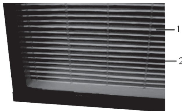
Рис.2 Фрагмент фильтра с нитевыми сепараторами; 1 – фильтрующий материал;
